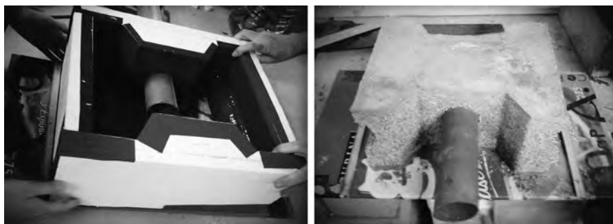
Fig. 2 – Produzione di blocchi con materiale di scarto, aggregati e leganti
