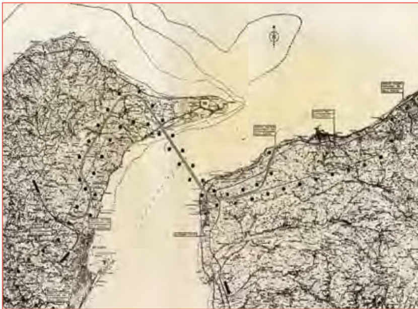
Figura 4 - Progetto delle gallerie subalvee stradali e ferroviarie proposte dalla Società Umberto Girola S.p.A. [Fonte: Ingegneria Ferroviaria, Luglio/Agosto 1979].
