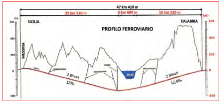
Figura 5 - Profilo altimetrico del tracciato ferroviario in tunnel sottomarino già ipotizzato dal Gruppo Umberto Girola [30].
